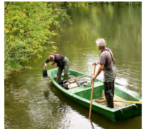
Abb. 2: Beprobung der wirbellosen Wassertiere mit einem Ekman-Birge-Bodengreifer in der Spree bei Bräsinchen, unterhalb der Talsperre Spremberg im September 2021
